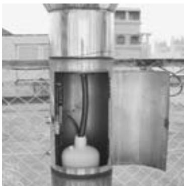
写真4 降下物採取装置
