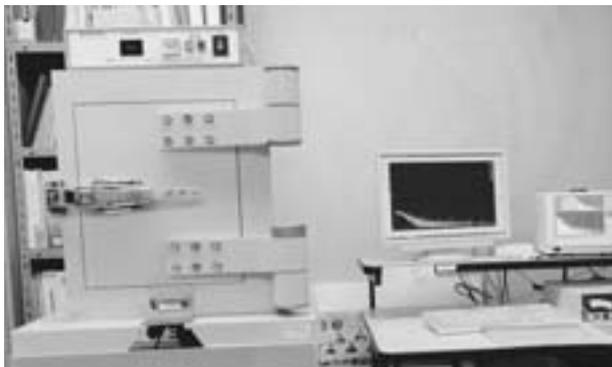
写真3 ゲルマニウム半導体核種分析装置
