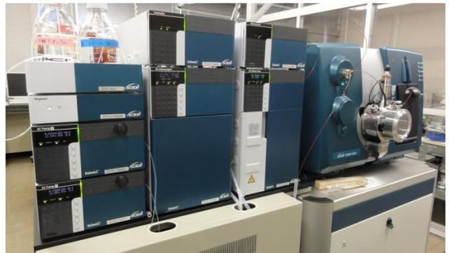
写真：液体クロマトグラフ・タンデム質量分析計（LC-MS/MS）
