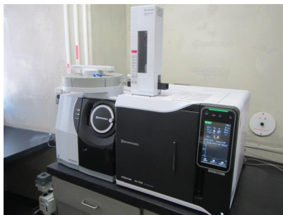
写真 ガスクロマトグラフ・タンデム質量分析計 (GC-MS/MS)
