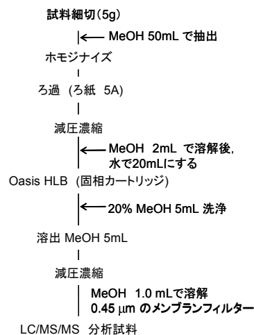
図3. 試料溶液の調整法
